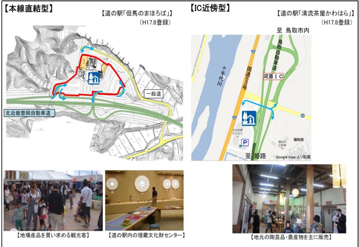
図.1 本線と「道の駅」の接続方法
