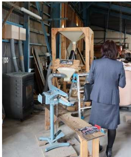
ペレットを小分けするための自作機械
